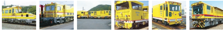
軌道検測車「EM30」 軌間、水準、高低、通り、平面性を検測します。 マルチプルタイタンパー「08-16U」 軌道の保守（軌道の高低、通り、水準）をする作業車です。 バラストフィニッシャー「802B号車」 マルチプルタイタンパー作業後の軌道整備時に活躍します。 モーターカー「105D号車」 ダンプトロリなどを牽引し、レールや砕石を運搬します。 遠隔制御車「RC701C号車」 道床砕石や残土を積載し、低床トロッコの端部で活躍します。 レール削正車「RG301」 レール頭部の形状を適切に保つため、レール頭部を削る作業車です。
